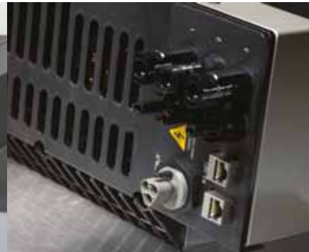
Mehrfach-Stringeingänge mit drei unabhängigen PV-Eingängen mit jeweils eigenem MPP-Tracker.
